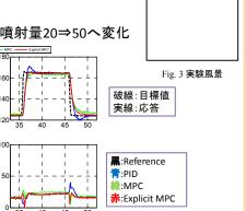
従来手法であるPID制御よりも,オーバーシュートの抑制された 良好な応答を確認
