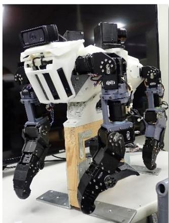
このロボットには、可動式の二次元測域センサー、タッチセンサー、力センサー、IMU センサーなど、ロボットの直面している状況を知覚するための多くのセンサーの他、不整地での移動やはしごの昇降などを行うための機構など、複雑なシステムが組み込まれています。また、物体やはしごの検知、位置特定を行うことができる AI に基づく認知モデルを持ち、限られた仕組みで垂直のはしごを上る能力を持つ新しい、ユニークな動きをするロボットだと思います。可動式の二次元測域センサーにより 360 度見渡すことができ、ハシゴを含めた外界の
