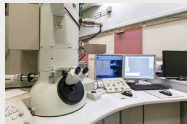
原子レベルの観察を可能とする最新鋭の透過型電子顕微鏡
