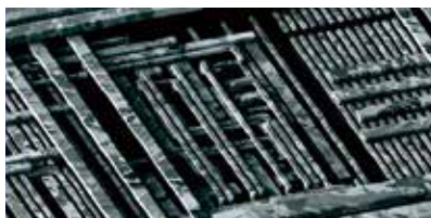
LSIチップの表面 (配管のように見えているものはすべて信号線)
