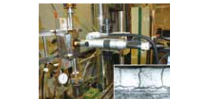
遮熱コーティングの損傷挙動その場観察装置と800℃におけるクリープ損傷例
