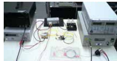
光通信機器を用いた風速測定用レーザー光源
