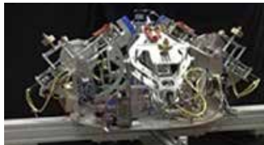
コントロールモーメントジャイロ実験装置
