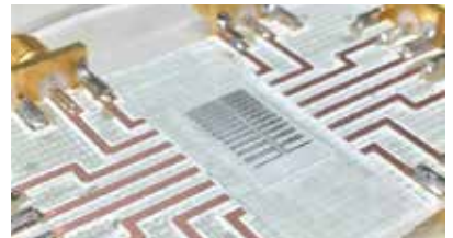
作製した多チャンネル弾性表面波デバイス
