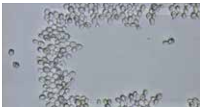
誘電泳動を用いた酵母群の選択的濃縮
