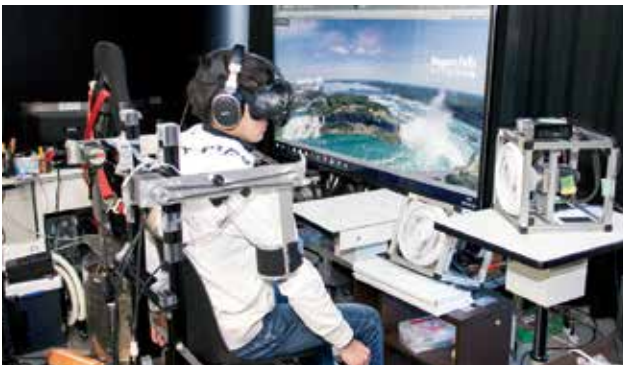
五感情報提示型のバーチャルリアリティ装置による臨場感の実験
