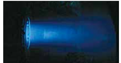
真空環境下でのイオンエンジン噴射実験
