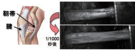
家兎膝蓋腱の衝撃引張試験。1/1000秒の間に30%伸びている。
