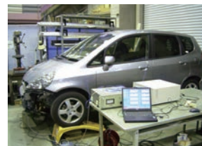
自動車ボディの加振実験
